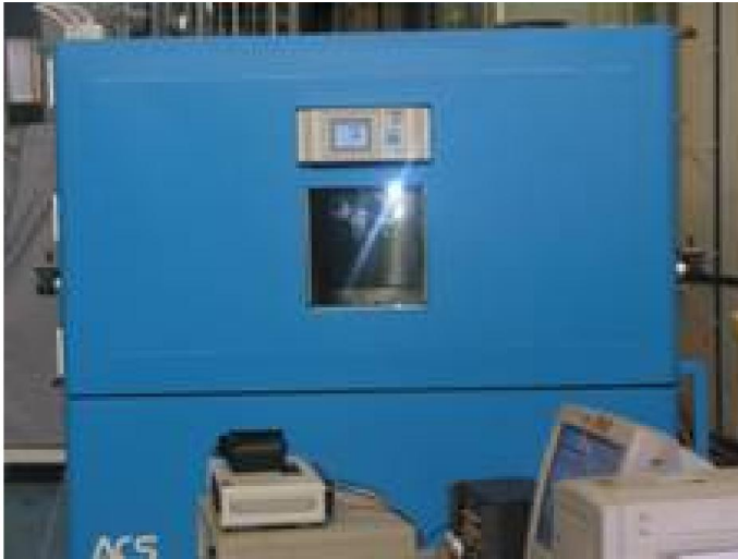
Climatic Chamber Per analisi dinamica su coupons (damping)
